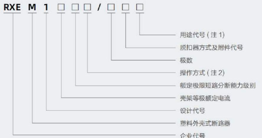
注: 1. 配电用断路器无代号; 保护电动机用断路器以 2 表示。
